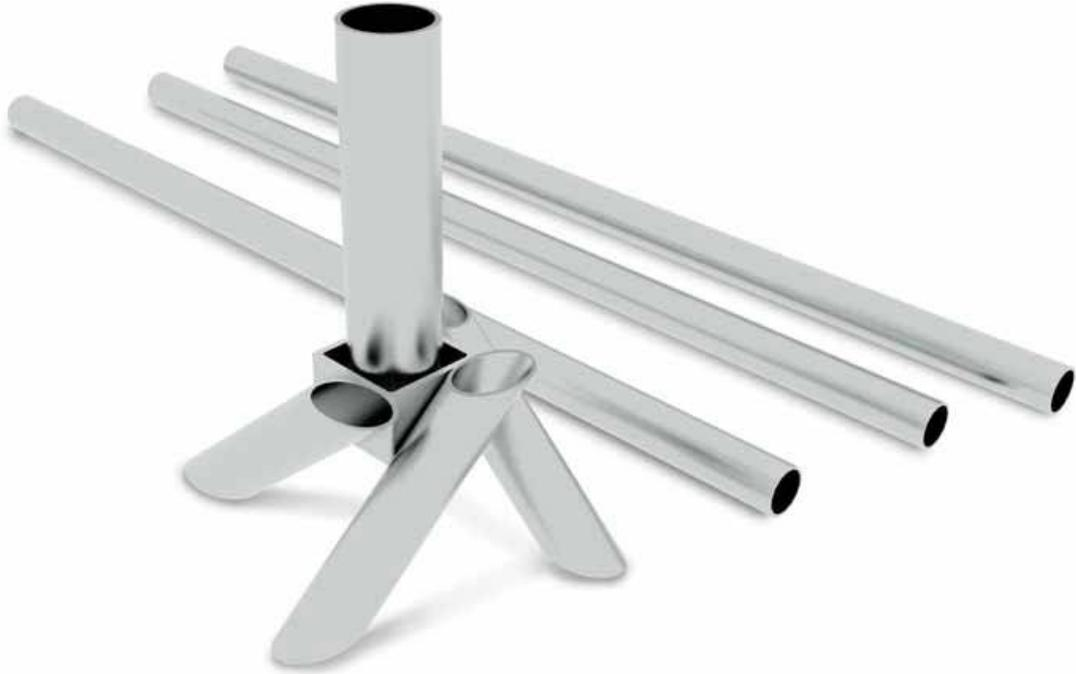
DESCRIPTION: installation du dispositif d'ancrage sur un terrain avec pôles qui supportent les panneaux de signalisation. Ancré avec 3 guides et des inserts d'ancrage de longueur variable. Réalisé avec de l'Acier S235JR galvanisé et trempé à chaud afin d'en préserver la résistance dans le temps.
